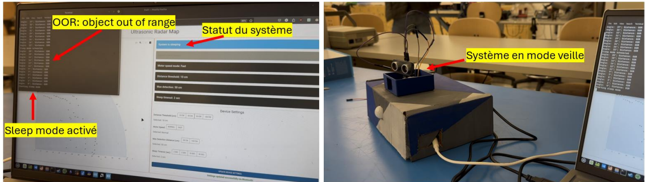
Figure 10 : Activation du mode veille lorsqu'il n'a aucune détection
